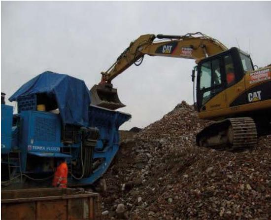
Beschickung der Brecheranlage
