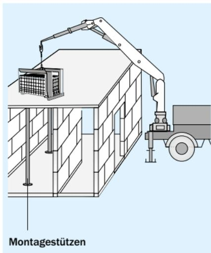
Bei zu hoher Belastung der Geschosdecken werden in Abstimmung mit dem Statiker erforderliche Montagestützen gesetzt.
