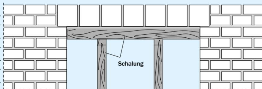
Ein aus KS-U-Schalen gemauerter Sturz ist bis zum Aushärten des Betons abzustützen.
