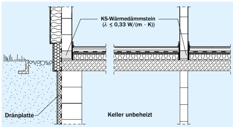
**Einsatzgebiete des KS-Wärmedämmsteins (beispielhaft), unterste Steinschicht über nicht beheizten Kellern**
